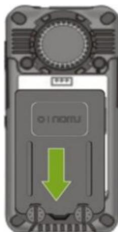
Beim Einlegen des Akkus die oberen Rastnasen ins Gehäuse führen und dann den Akku fest andrücken. Den Akku mit Hilfe der Schlitzschrauben fixieren. Stellen Sie sicher, dass der Akku richtig installiert ist bevor Sie das Gerät einschalten.
